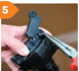
Replace the pivot pin.
